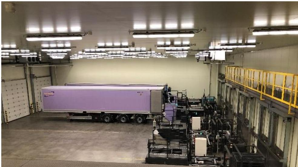
低温で管理され、トレーラーヘッドを切り離しシャッター閉鎖。庫内裏側よりトレーラーの高さでパレットに積載された長いもが搬出され、箱を手積み作業。(フォークリフト不要)
