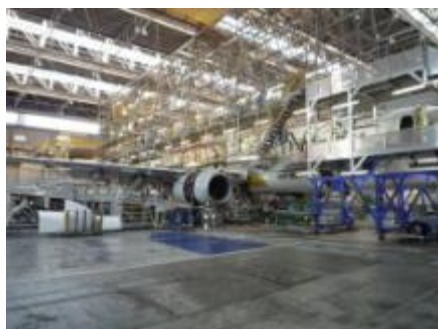
No.2 Dock 手前から 左側に置いてあるのは外された エンジンの外側
