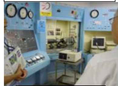
バルブ類の試験装置
