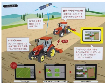
自動運転トラクターのシステム概要(©ヤンマー)
