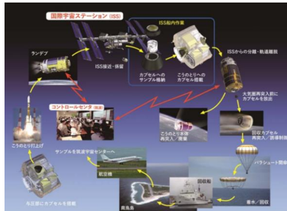
図V-3 HTV 搭載小型回収カプセルの運用概念図 (出典：JAXA)
