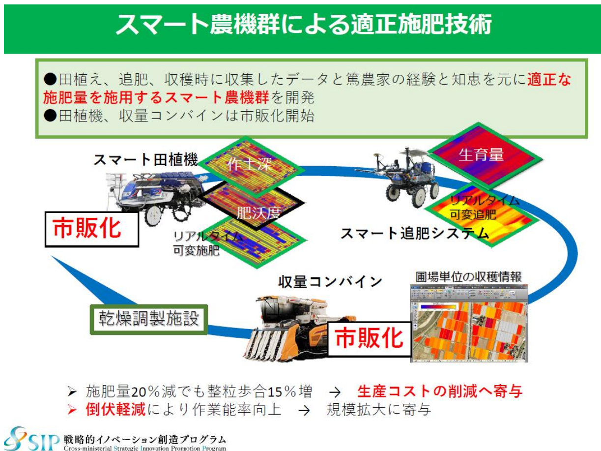
図6 スマート農機群による適正施肥技術
