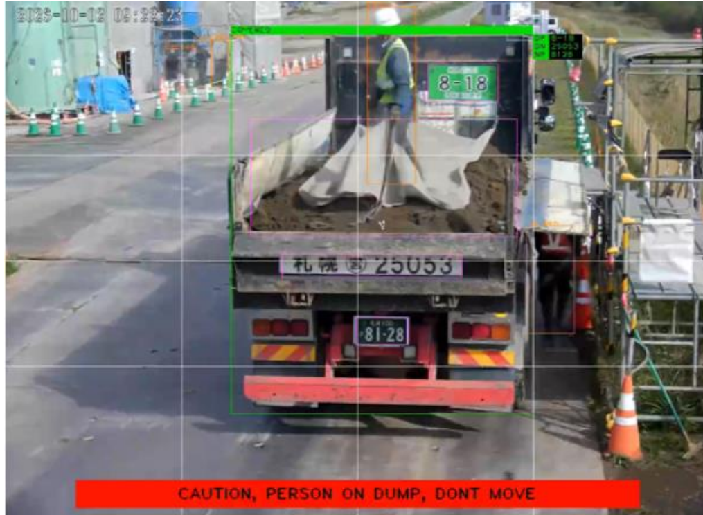
画像認識AIが荷台に人がいることを認識し回転灯を点灯
