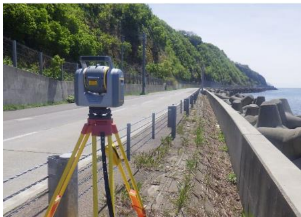
レーザースキャナによる測量
